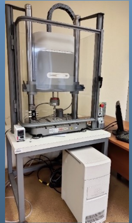
Испытательная машина Instron ElectroPuls E3000, Instron, США
