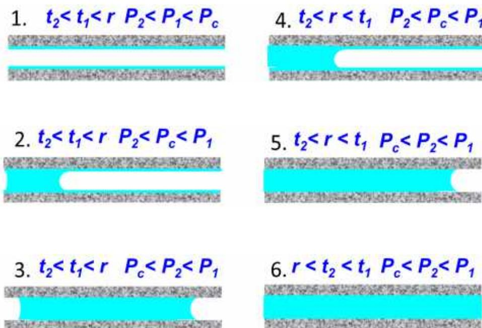
**Рис.2.8.** Режимы транспорта конденсируемых компонентов через цилиндрический канал.
